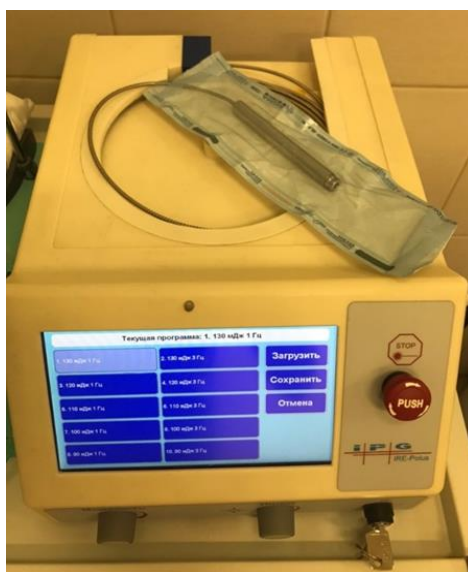
Рисунок 43 – Лазерный хирургический аппарат ЛСП «ИРЭ-Полюс» для проведения лазерной терапии в зоне установленных дентальных имплантатов
