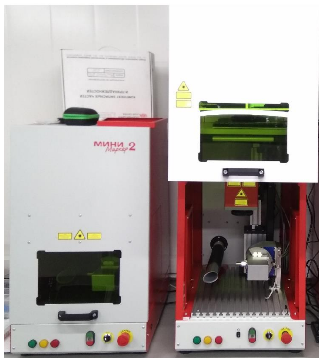
Рисунок 85 – Иттербиевый волоконный импульсный лазер МиниМаркер 2 с длиной волны 1064 нм
