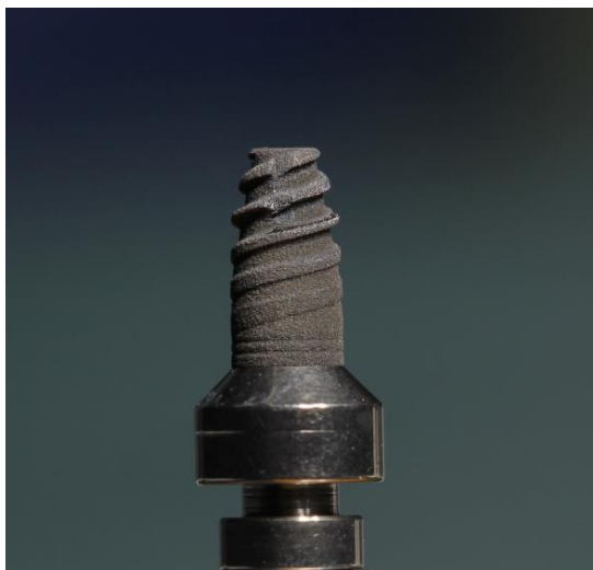
Рисунок 88 – Внешний вид дентального имплантата с К-структурой поверхности (по типу «канавки»).
