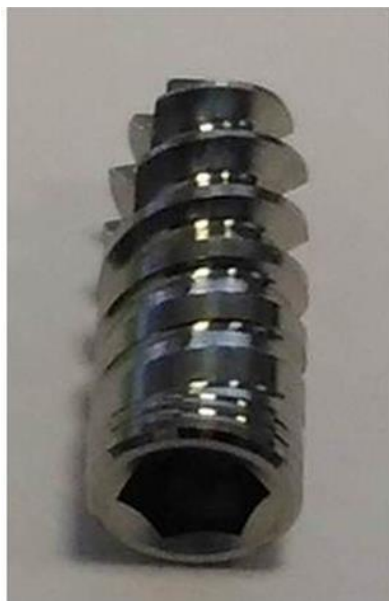
Рисунок 86 – Вид дентального имплантата без механической обработки поверхности, до проведения лазерного структурирования
