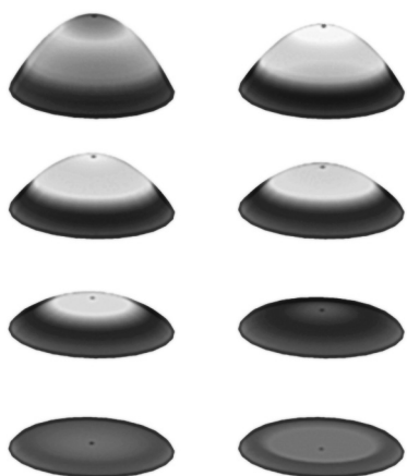
Рис. 1. Изменение формы капли биологической жидкости, высыхающей на твердом горизонтальном основании. Расчеты проведены с использованием нашей модели, описанной в работе [9]. Рисунки сильно растянуты по вертикальной оси для большей информативности. На последнем рисунке хорошо виден валик на краю высохшей капли
