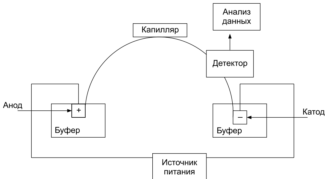
Рис. 1. Схема капиллярного электрофореза
