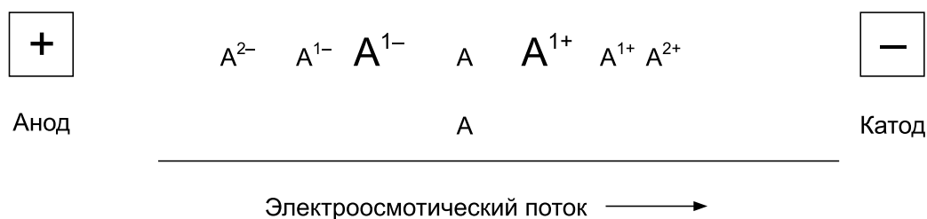
Рис. 3. Движение заряженных частиц в электроосмотическом потоке
