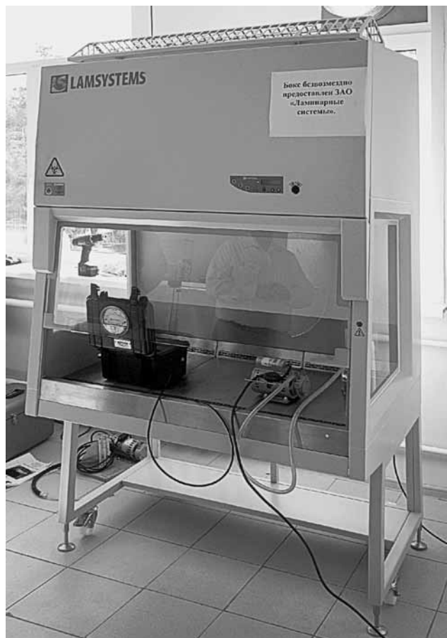
Бокс микробиологической безопасности производства ЗАО «Ламинарные системы» на тестовых испытаниях в учебном классе областного ПТД, г. Владимир
