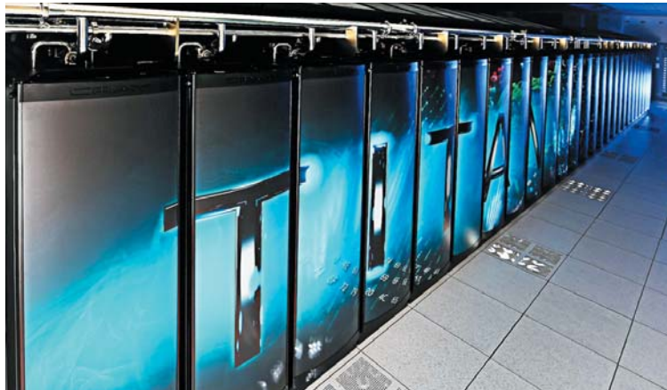
Суперкомпьютеры «Титан» и «Кракен», располагающиеся в Окриджской лаборатории и используемые для самых сложных задач. «Титан» занимает площадь более 400 кв. метров; внутри каждого из 200 его «отделений» находится 24 индивидуальных компьютера многопроцессорной гибридной конфигурации. В целом же, по словам И.Б. Жулина, в биоинформатике использование таких огромных машин – редкость, большинство «ежедневных» задач решается на обычных настольных компьютерах
