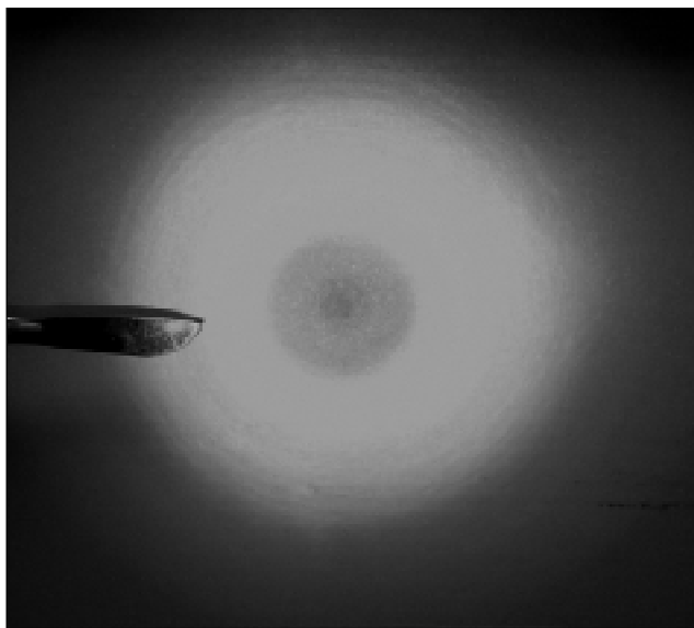
Рис. 2. Проверка качества среза оптоволоконна
